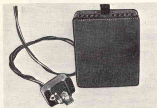
Vista interna ed esterna del ronzatore che mostra come l'apparecchio possa essere interamente montato in un mobiletto di plastica per altoparlanti.
